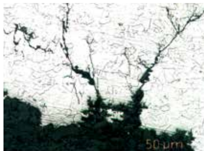
Primjer za transkristaline naponske korozije na 1.4401 (A4) kod jake izloženosti kloru !
